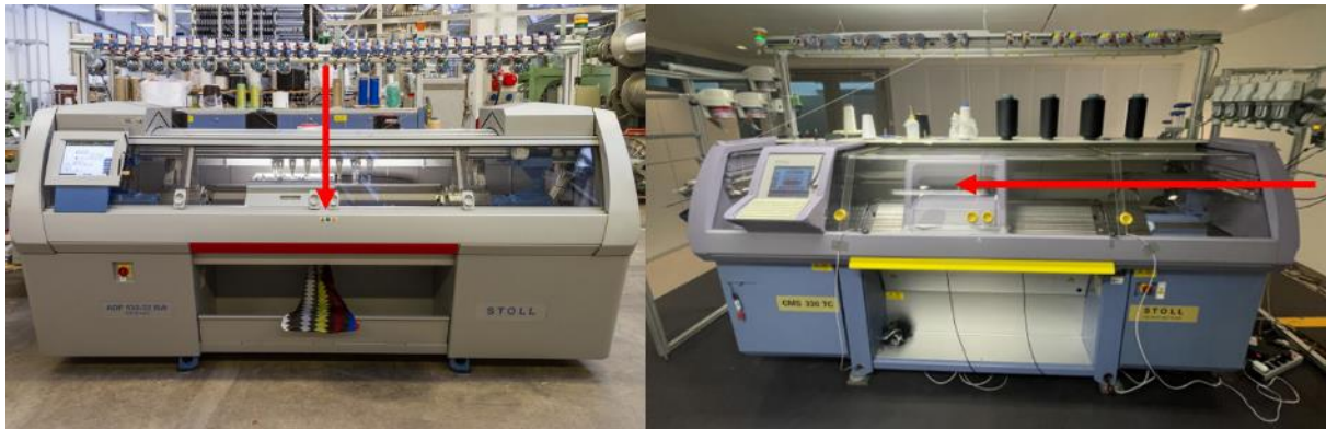
Abbildung 7: Die untersuchten Flachstrickmaschinen für die Messkampagnen im Labor- (links) und Produktionsumfeld (rechts) mit visualisiertem Fadenlauf (rote Pfeile).
