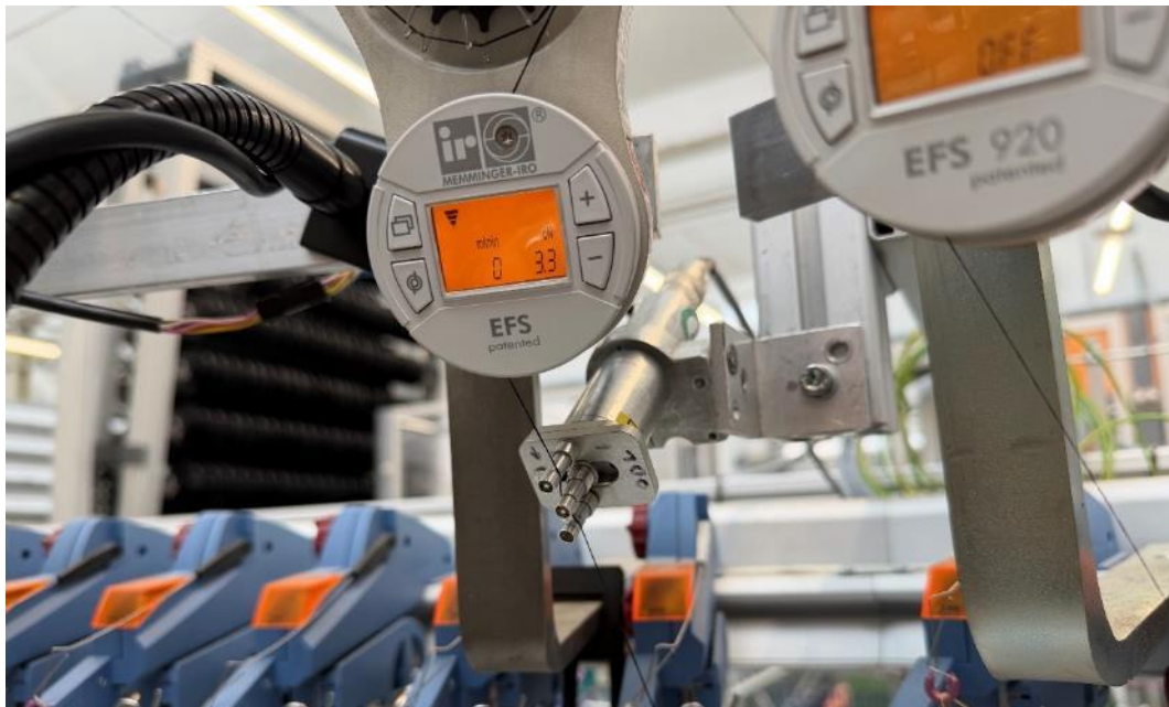
Abbildung 4: Modifizierter Fournisseur und 3-Rollen-Fadenzugkraftsensor statisch montiert oberhalb der Maschine.
