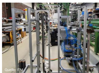
Umgesetzte, modulare Zusatzeinheit für das Inline-variiieren der Schussfäden
