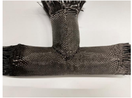
Abbildung 5: RTM-Werkzeug für die Konsolidierung (links); Rohrknoten ausgeformt (rechts)
