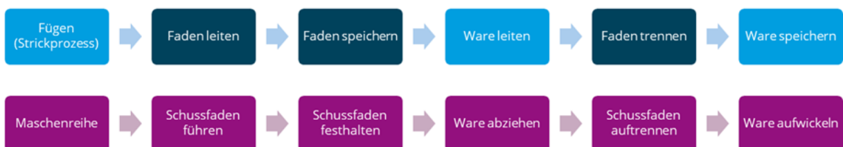
Abbildung 6: Funktionsstruktur Flachstrickmaschine mit Zusatzeinrichtung zum Schussfaden speichern, trennen und wiederzuführen
