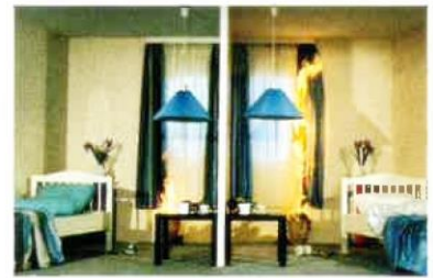
In der Brandversuchsanlage von Hoechst wird im direkten Vergleich schwerentflammables TREVIRA CS (jeweils links) gegen herkömm-
