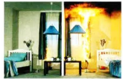
liche Textilien (jeweils rechts) getestet. Bereits nach 60 sec. steht die herkömmliche Dekoration in hellen Flammen. Während bei TREVIRA CS
