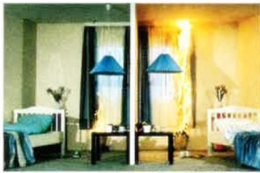
liche Textilien (jeweils rechts) getestet. Bereits nach 60 sec. steht die herkömmliche Dekoration in hellen Flammen. Während bei TREVIRA CS
