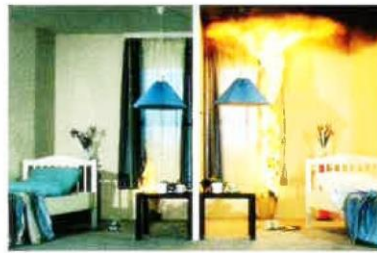
liche Textilien (jeweils rechts) getestet. Bereits nach 60 sec. steht die herkömmliche Dekoration in hellen Flammen. Während bei TREVIRA CS
