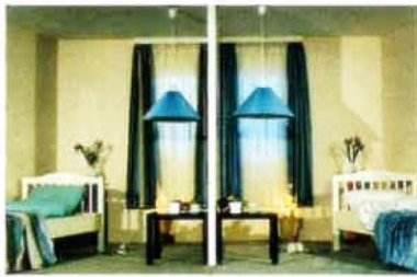
In der Brandversuchsanlage von Hoechst wird im direkten Vergleich schwerentflammables TREVIRA CS (jeweils links) gegen herkömm-
