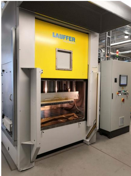
Heißpresse an den DITF, Lauffer VCP 500, Foto: DITF
