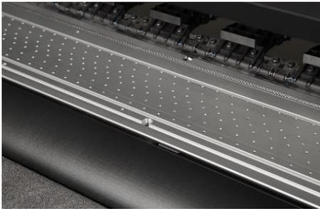
*Der Mimaki Textildirektdrucker Tx300P-1800 Mkl hat eine leicht austauschbare Auflagefläche, die zusätzlich den Druck auf Transferpapier ermöglicht.*
