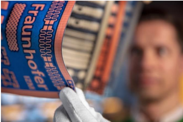
Textile Leiterplatte des Projekts TexPCB (Foto: Fraunhofer IZM, Volker Mai)
