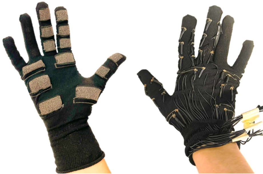
Abbildung 7: S^{3D} – Funktionsdemonstrator (Vorder- und Rückseite) realisiert als vollständig gestrickter Handschuh mit 13 kapazitiven Drucksensoren
