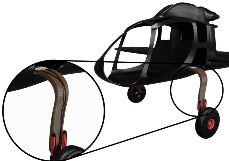
Abbildung 1.1: Federbein im Prototypen eines Ultraleichtflugzeugs als CAD Modell, Quelle: ITA
