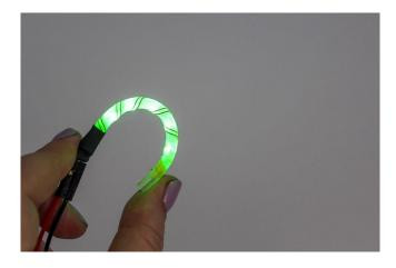
Die 3D-Struktur des Bandes ermöglicht, dass es nicht nur flexibel, sondern auch dehnbar ist.
