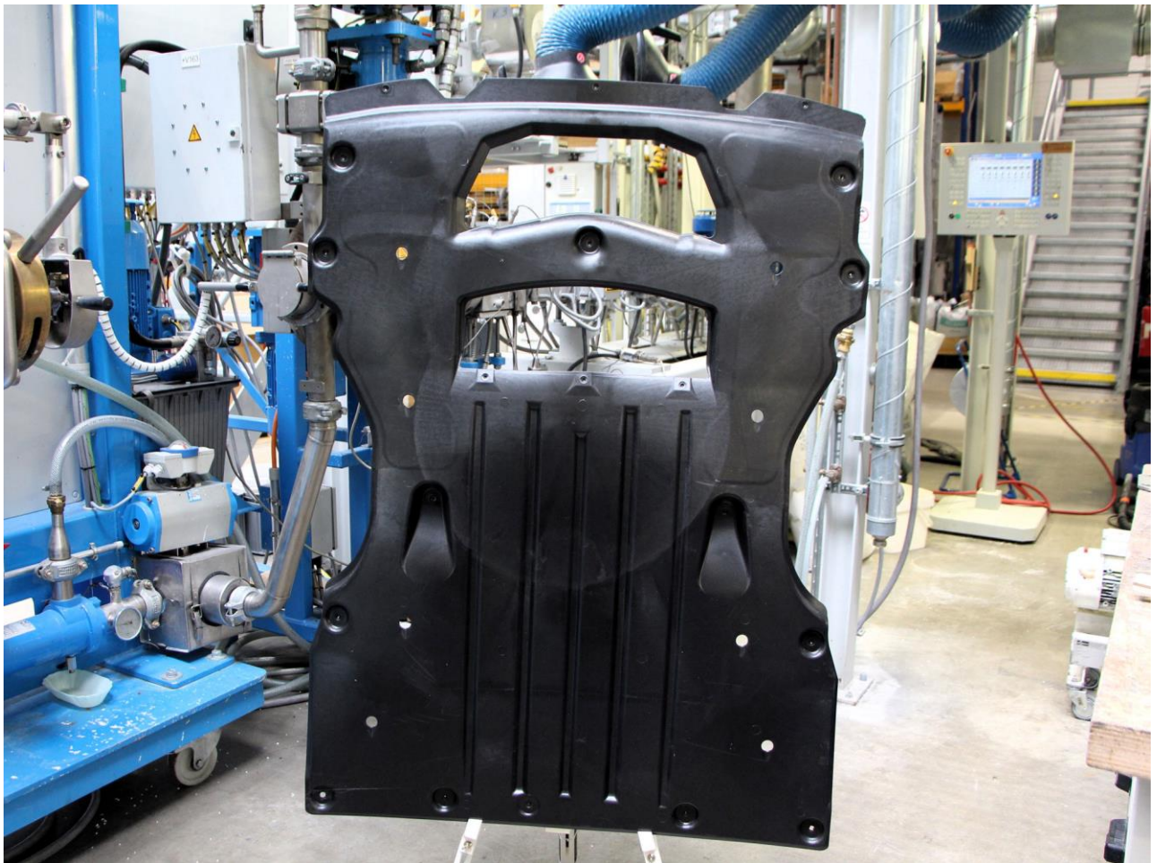
Im Spritzgussverfahren hergestellte Dämpfungswanne aus dem vorderen Fahrzeugunterboden aus Naturfasern und Post-Consumer-Rezyklat (Polypropylen) mit einer Breite von 92,8 cm und 128,8 cm Höhe, die Wandstärke beträgt 2 mm.
