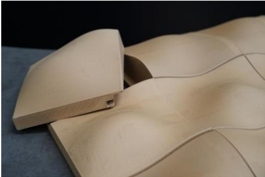
Erste Versuche mit gedruckten Freiformkacheln aus Holzkurzfaserfilament. (Foto: LZH)
