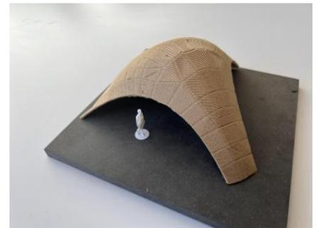
Modell eines Pavillons mit 3D-gedruckten Fassadenelementen. (Foto: BioMat am ITKE, Universität Stuttgart)
