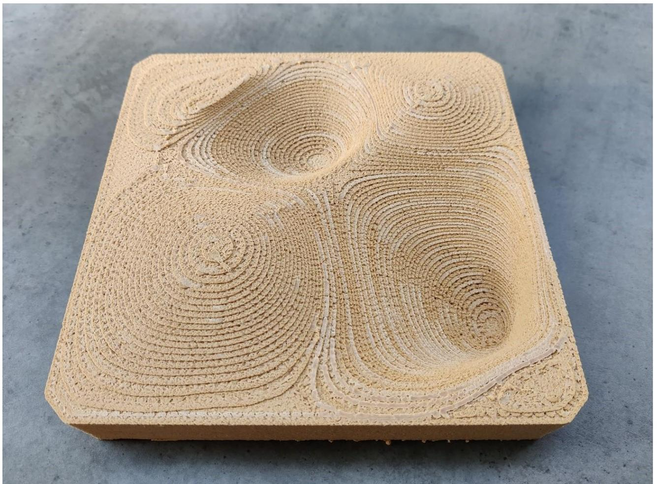
Im Projekt 3DNaturDruck sollen Bauelemente aus Naturfasern additiv gefertigt werden, wie hier eine Freiformkachel aus Holzkurzfasern (Foto: LZH Laser Zentrum Hannover e.V.).
