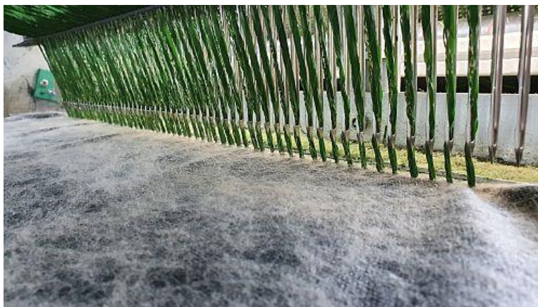
Im Betrieb der Tuftingmaschine am TFI stechen die Nadeln in das Trägermaterial (weiß) und bringen so das Polgarn für den Kunstrasen (grün) ein. Bildquelle: TFI
