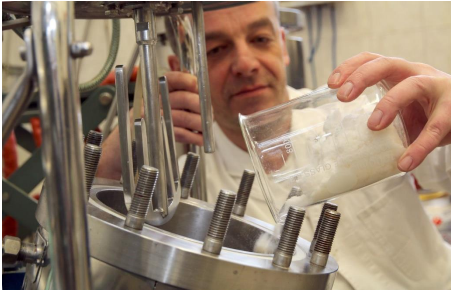
Dr. Jens Schaller, Projektleiter am TITK bestückt einen Edelstahlreaktor mit Cellulose, um daraus spezielle Celluloseether herzustellen. Bildquelle: TITK/Steffen Beikirch
