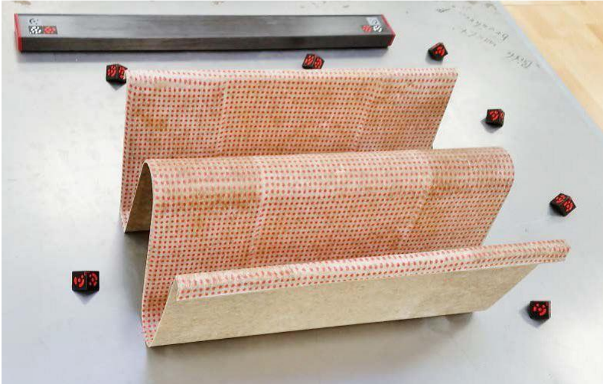
Optische Vermessung des Umformteils und der tatsächlichen Umformgrade, Foto: SachsenLeinen GmbH
